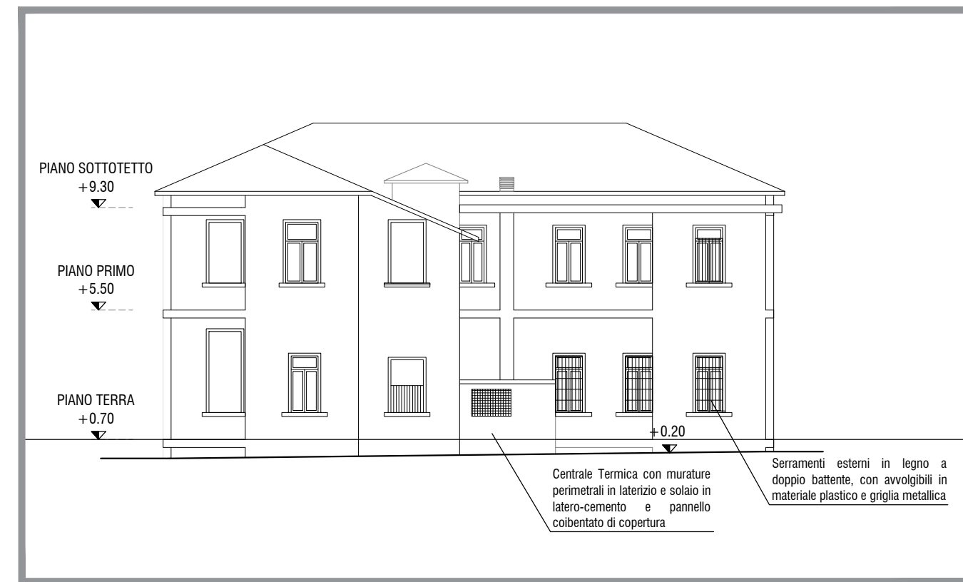
PROSPETTO EST - STATO DI FATTO - SCALA 1:200
